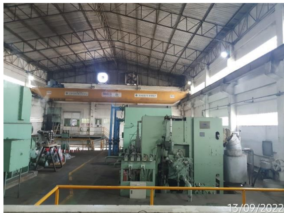
รูปที่ 22 การปิดครอบเครื่องจักรอุปกรณ์ที่มีเสียงดัง
